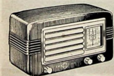
Champion „Komet“. Kleinsuper der Champion Electric Corp. Fünfrohrengerät, nur für Ausfuhr bestimmt
